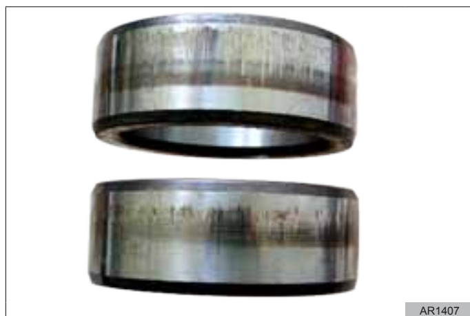
Рис. 35 Углубления на дорожках качения внутренних колец подшипников
