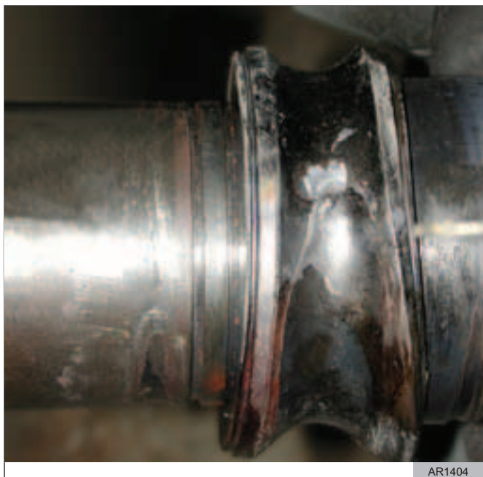
Рис. 32 Перегрев подшипника из-за слишком плотного прилегания к корпусу
