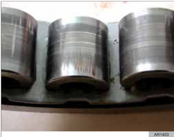
Рис. 31 Углубления и царапины на роликах могут возникнуть, когда внутреннее кольцо цилиндрического подшипника было криво вставлено во внешнее кольцо с роликами
