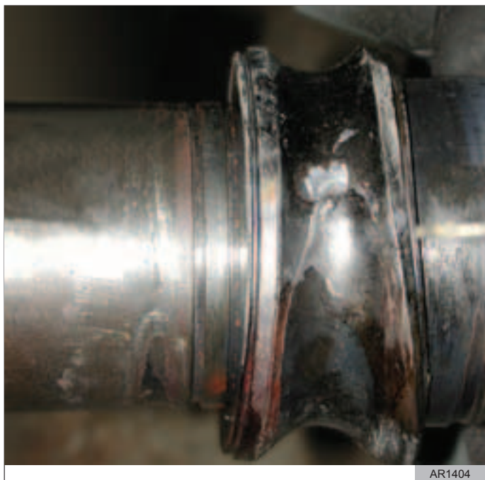
Rys. 32 Przegrzanie łożyska wskutek zbyt ciasnego pasowania w oprawie
