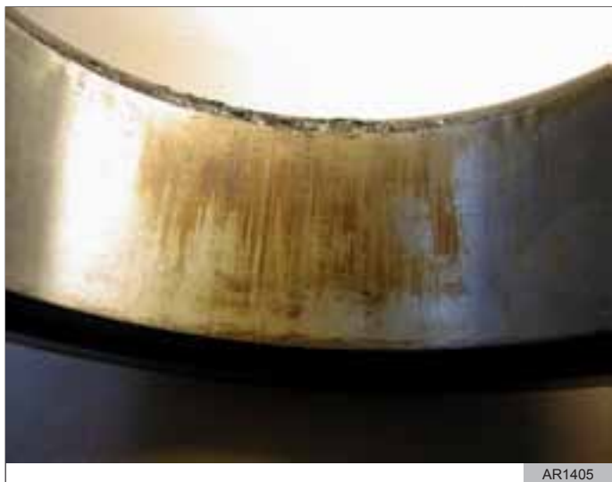
Рис. 33 Повреждение внешней дорожки качения подшипника из-за коррозии
