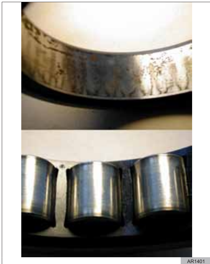
Рис. 29 Перегретые элементы роликового подшипника
