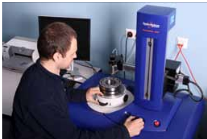
Рис. 16 Измерения производимые на устройстве Talugond 365
