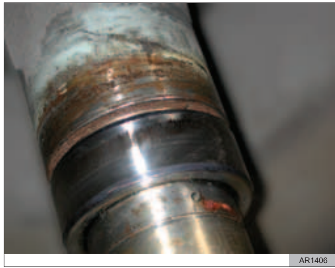
Рис. 34 Углубления на дорожке внутреннего кольца подшипника образовавшиеся из-за передачи вибрации от работающего соседнего оборудования на вращающийся подшипник
