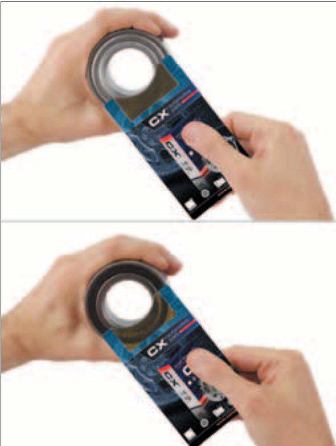
Рис. 12 Определение активной стороны подшипника с помощью детекционной ленты
