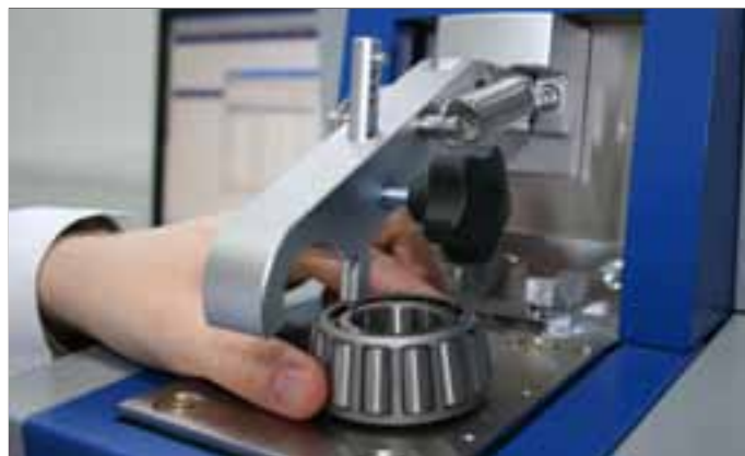
Rys. 17 Pomiar dokonywany na urządzeniu Spectromax
