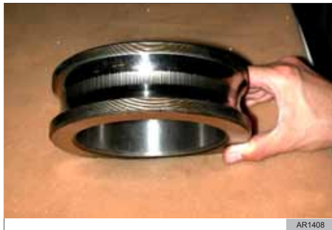
Рис. 36 Углубления на дорожке качения внутреннего кольца подшипника, возникшие в результате поступления электрического тока
