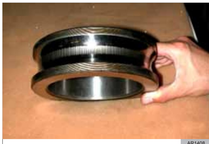
Rys. 36 Wgłębienia na bieżni pierścienia wewnętrznego łożyska powstałe w wyniku przepływu prądu
