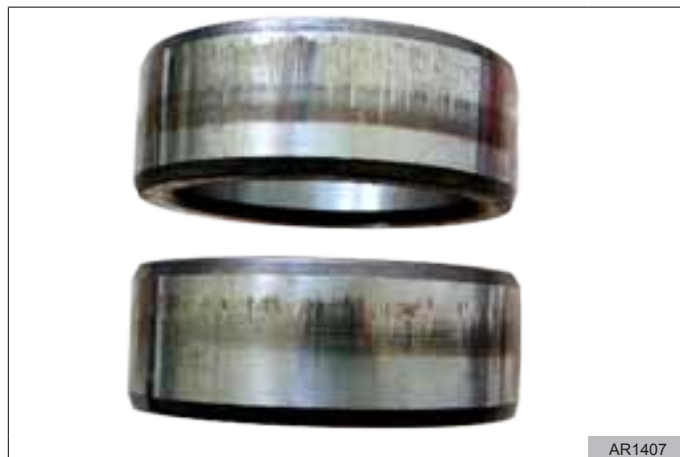
Rys. 35 Wgłębienia na bieżniach pierścieni wewnętrznych łożysk
