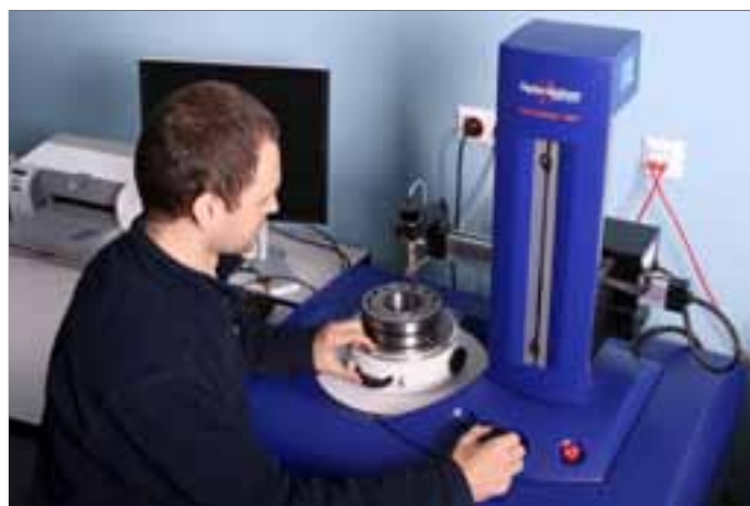
Rys. 16 Pomiar dokonywany na urządzeniu Talyrond 365
